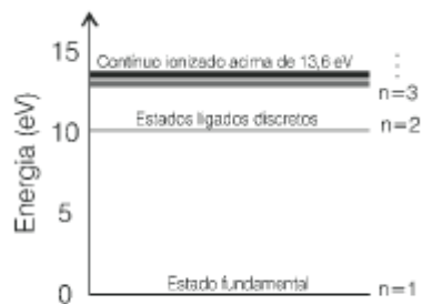
Figura 2: Diagrama de níveis de energia para o átomo de hidrogênio.
