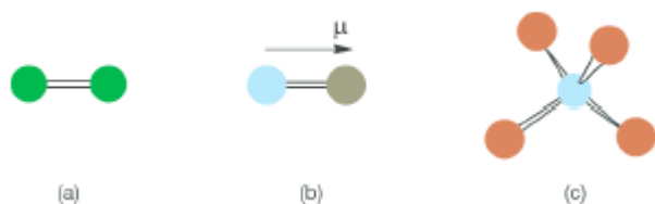
Figura 4: Desenho de molécula diatômica homonuclear, mostrando momento de dipolo nulo (a), molécula diatômica heteronuclear, mostrando momento de dipolo diferente de zero (b) e tetracloro de carbono, cujas ligações químicas são polares, mas a geometria anula as contribuições, originando momento de dipolo igual a zero (c).
