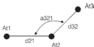
Figura 1: Representação do comprimento de ligação ( d_{21} e d_{32} ) e ângulo de ligação ( a_{321} ) definidos pelos átomos At1, At2 e At3.
