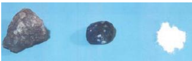
Figura 4: Sodalita: mineral bruto, à esquerda; no centro, sodalita polida e à direita uma amostra de sodalita sintética.
